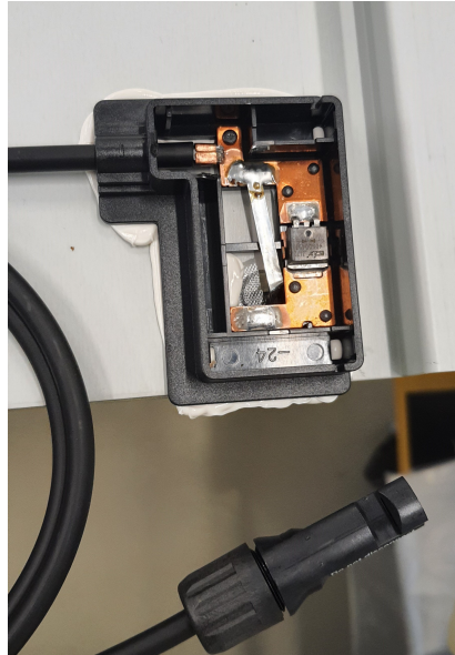
Abbildung 32: Innenansicht der Anschlussdose und Montage mit Silikon
