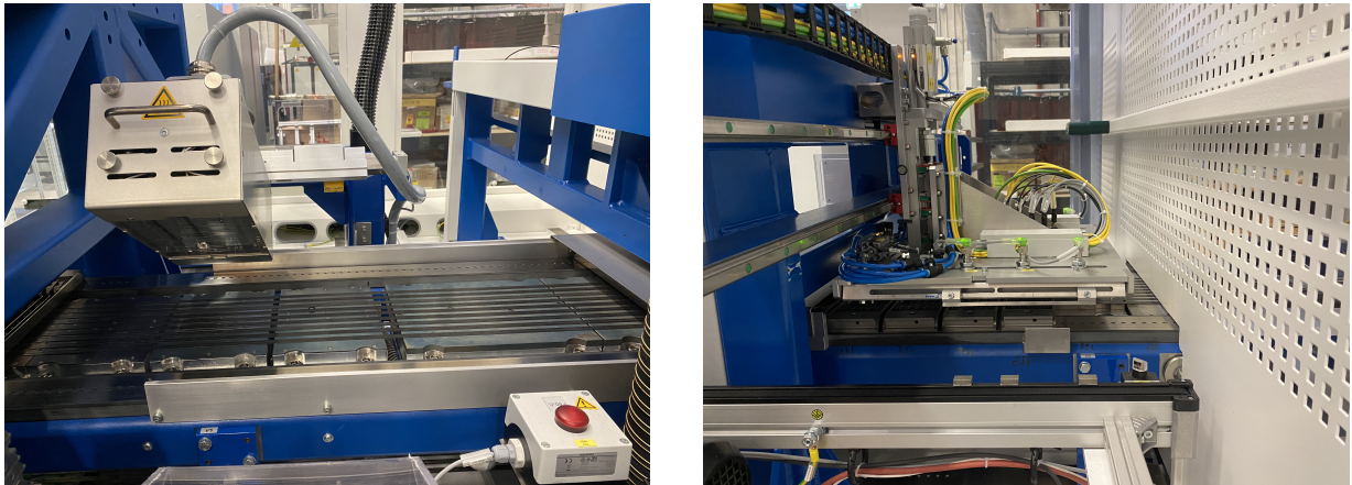
Abbildung 26: Seitenansicht der Heizmodule (2-5) ohne Niederhalter (links) und Seitenansicht der Heizmodule (6-7) mit der Niederhalterentnahme (rechts); mit der Orientierung von rechts nach links
