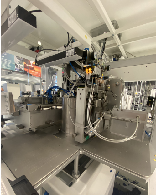
Abbildung 24: Seitenansicht des Rundschalttisches (links) und Druckeinheit mit Sieb und aufgetragenen ECA in geflutetem Zustand (rechts)
