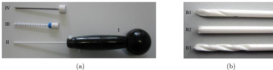
Abbildung 5.23: (a) MR-kompatibles Knochenbiopsiesystem [137] bestehend aus (I) Handgerät, (II) Keramikbohrer, (III) koaxiale Kanüle, (IV) Mandrin. (b) Je nach Anwendungsfall werden verschiedene Bohrköpfe benötigt. So wurde ein langer Spiralbohrer mit exzentrischer Schneide (B1), ein Hohlbohrer mit Fräszähnen (B2), sowie ein Spiralbohrer (B3) in [137] vorgestellt.
