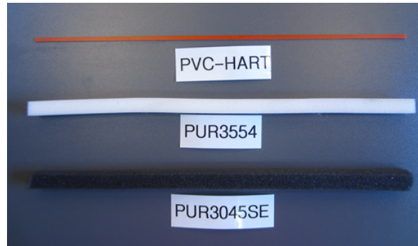
Abbildung 5.4: Probengröße und -beschaffenheit der Polyurethane und des PVC für die experimentellen Untersuchungen im DIN-Rohr
