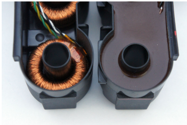
Abbildung 1.4: Verguss von Spulen in PPS Gehäuse. Links eine Ringkernspule vor dem Verguss, rechts umhüllt mit Epoxidharz (Bild: Siemens AG)
