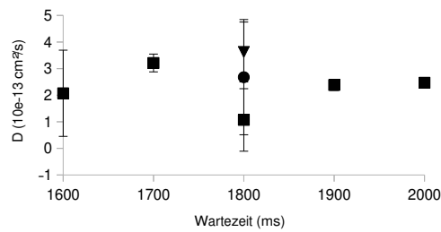
Abbildung 4.14: Variation der Diffusionskonstanten D mit der Länge D20 des Gradientenpulses bei 298 K (■). Abweichende Temperaturen bei 1800 ms: 303 K (●), 308 K (▼).
