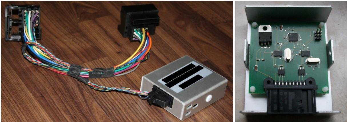
Abbildung 59: Kommerzielles Gerät zur TV-Freischaltung – Außen- und Innenansicht
