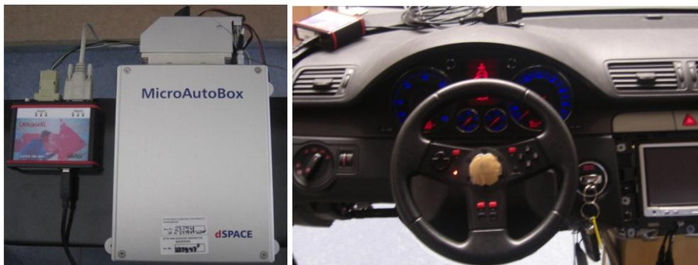
Abbildung 41: Prototyping-Hardware (dSPACE MicroAutoBox I) und Teile der Testumgebung
