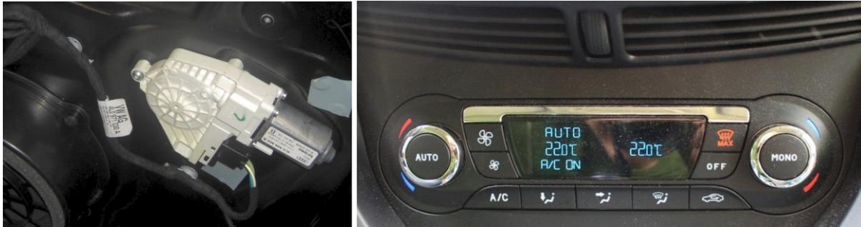
**Abbildung 10: Beispielhafte Steuergeräte (Türsteuergerät und Klimabedienteil)**
