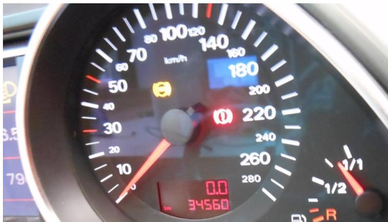
**Abbildung 67: Geänderter Kilometerstand auf dem Kombiinstrument im Laboraufbau M3**
