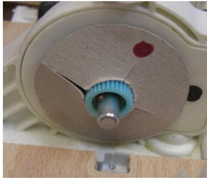
Abbildung 24: Elektrischer Fensterhebermotor (Teil des Türsteuergeräts) im Laboraufbau M2
