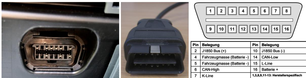
**Abbildung 12: Standardisierte OBD-Schnittstelle (Buchse, Stecker und Pinbelegung Buchse)**
