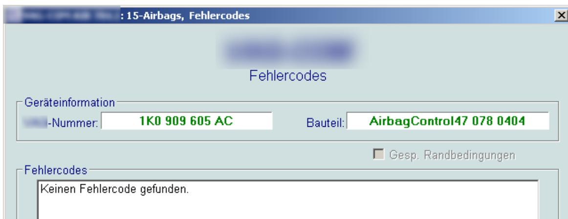
Abbildung 27: Fehlerspeicher-Ansicht der vorgetäuschten Airbag-ECU im Diagnosewerkzeug
