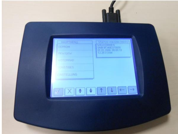
**Abbildung 65: Untersuchtes Gerät (plagiierte Version) zur Kilometerstandsmanipulation**
