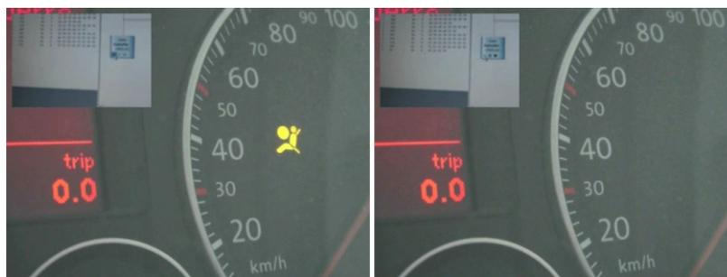
Abbildung 26: Unterdrückung der Airbag-Warnleuchte an Testaufbau M2
