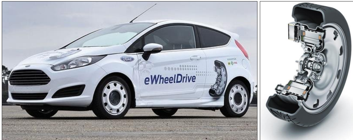
Abbildung 2.7: E-Wheel Drive (links), Radnabenmotor (rechts) der Schaeffler AG [60]
