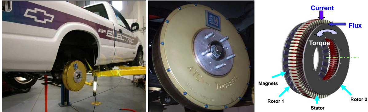
Abbildung 2.4: Radnabenmotor der General Motors Company LLC [50]
