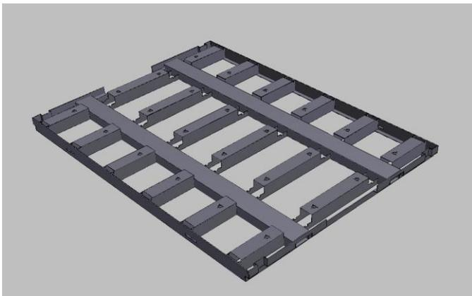
**Abbildung 7 Grundkonstruktion des Bodens**
