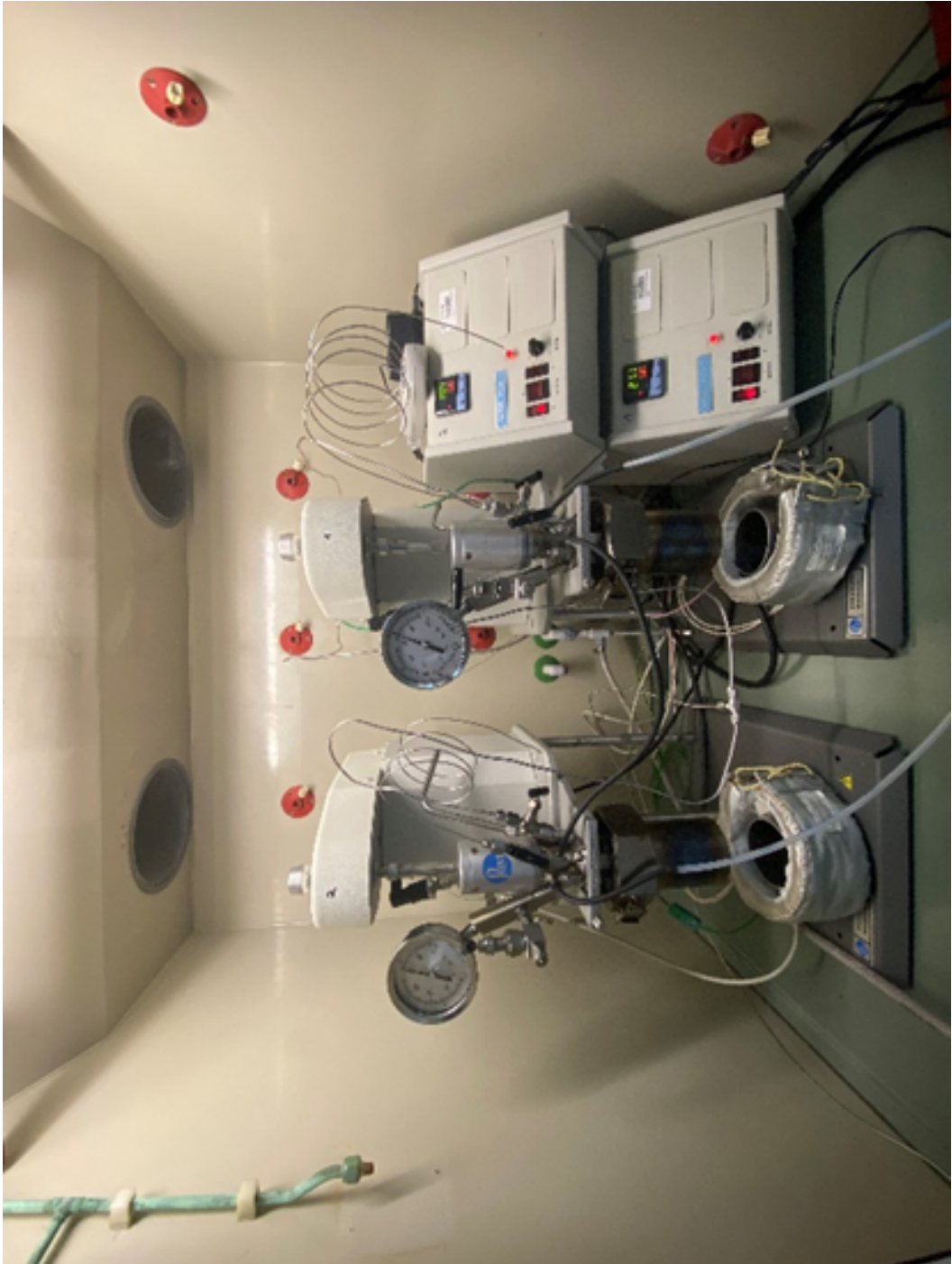
Abbildung 23: Versuchsaufbau der Alterungsversuche mit Reaktor 1 (rechts) und Reaktor 2 (links)
