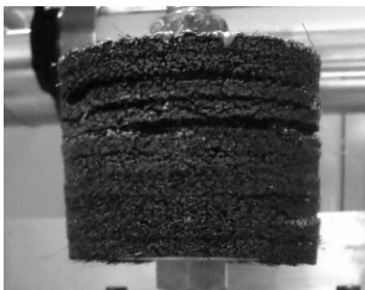
Abbildung 4.7: Konzept des Bürstens von Zylinderlauf­flächen mit losem Korn
