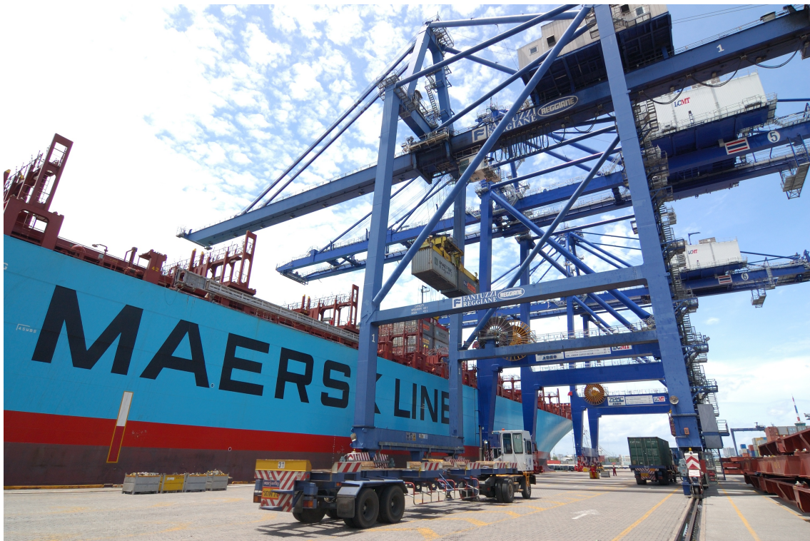
Abbildung 3.3: Containerbrücken beim Be- und Entladen eines Containerschiffs am Containerterminal Laem Chabang 1 (Thailand) (Quelle: Maersk Line)
