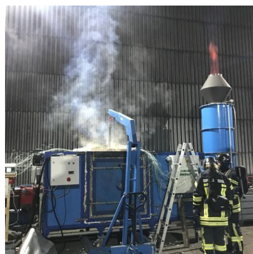
(d) Bauteilofen der Hochschule Magdeburg-Stendal während des Versuches
