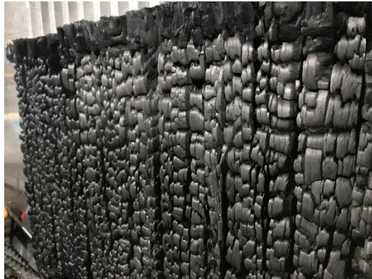
(a) Modifiziertes Buchenholz nach Versuch
