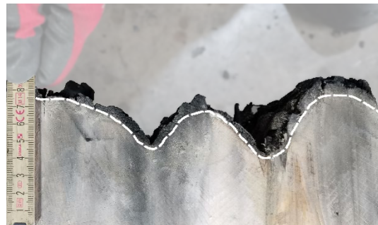
(c) Schnitt durch herkömmliches Buchenholz
