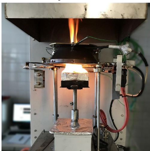
(c) Brennender Probekörper im Cone-Kalorimeter während des Versuches
