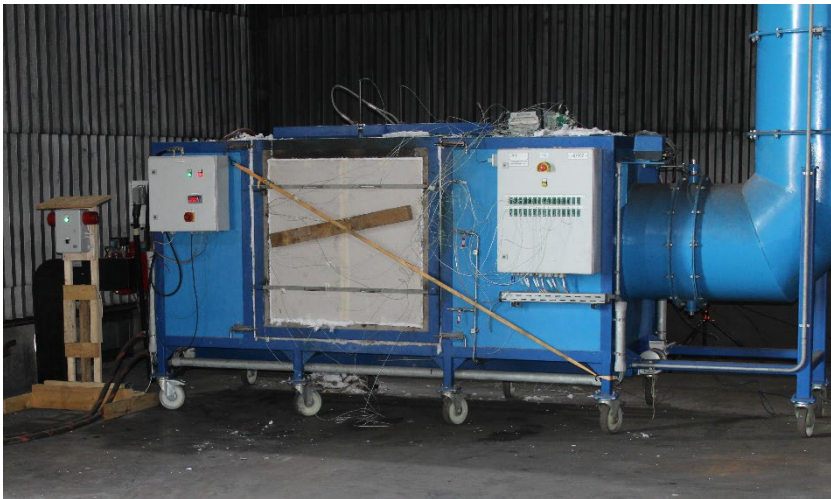
Abbildung 1 Bauteilofen H2 mit eingebauten Wandprobekörpern
