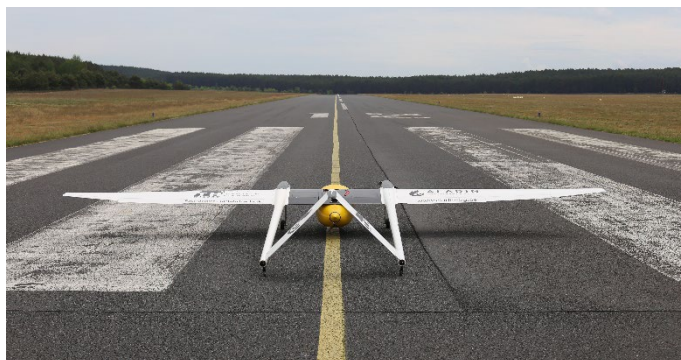
Abbildung 1: ATISS Starrflügeldrohne mit 5 m Spannweite und bis zu 25 kg Abfluggewicht
