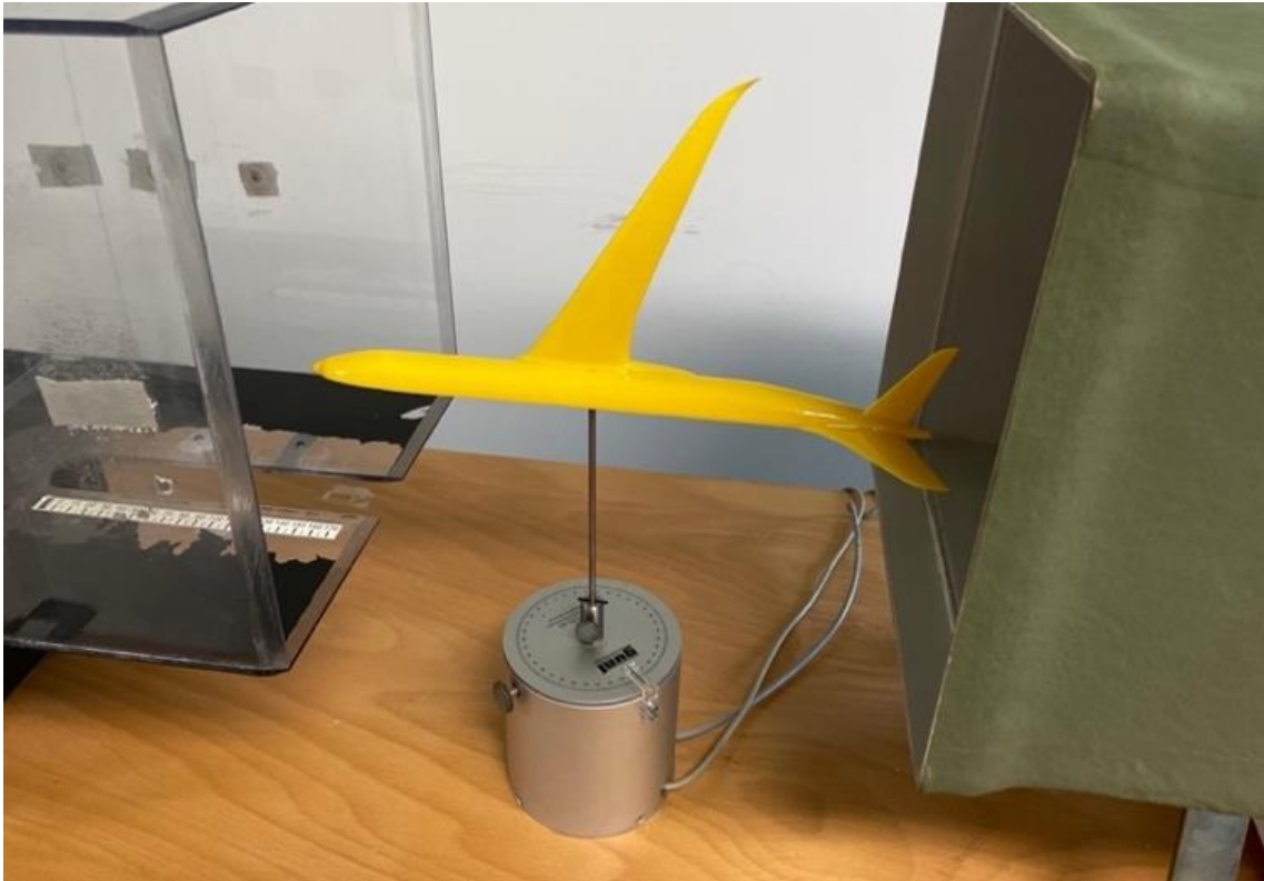
Abbildung 4: Im Kraftsensor befestigter Prüfkörper
