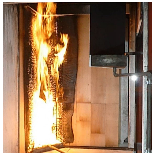
(b) Probekörper im SBI-Prüfstand während des Versuches
