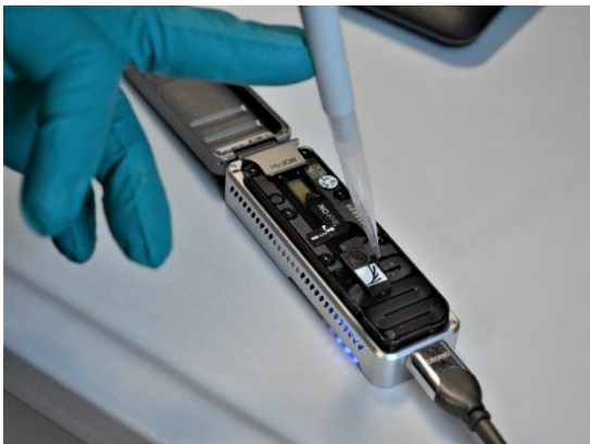
Abbildung 3: MinION Sequencer von Oxford Nanopore Technologies, der für den genetischen Test auf Varroaresistenz-eigenschaften verwendet werden soll.
