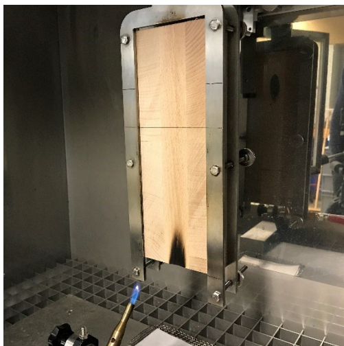
(a) Probekörper im Einzelflammentest nach der Beflammung
