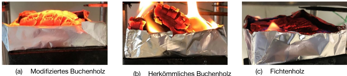
Abbildung 4 Probekörper im Cone-Kalorimeter unmittelbar vor Versuchsende. Der verkohlte Probekörper aus herkömmlichem Buchenholz ist deutlich verformt.
