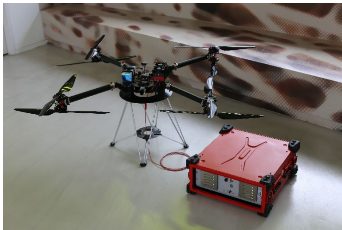
Abbildung 5: Relaisstation bestehend aus Octocopter mit Empfangs- und Sendetechnik und Tetherstation
