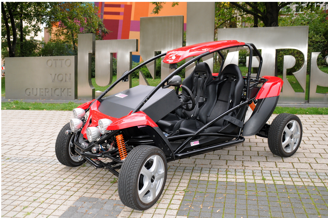
Abbildung 8.9: Modulträger Elektrofahrzeug: BugEE
