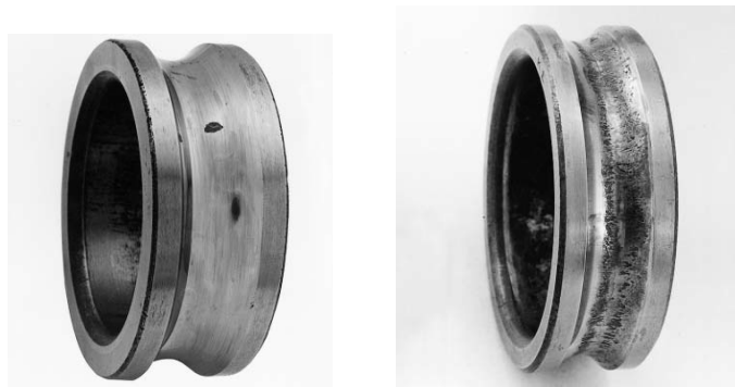
Abbildung 1.3: Ermüdungsschaden auf der Innenringlaufbahn. Links, Grübchen (Pitting). Rechts, fortgeschrittenes Stadium: Schälung (Abblätterung). Quelle: FAG (2006)
