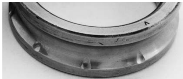
Abbildung 1.6: Eindruckstellen auf der Innenringlaufbahn. Quelle: FAG (2006)
