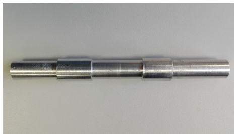
Abb. 4.19: Fixier-Tool für Transmissionsanordnung der Ultraschallwandler
