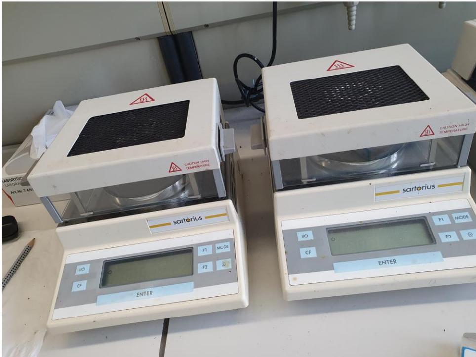
Abbildung 17: Trocknungswaage
