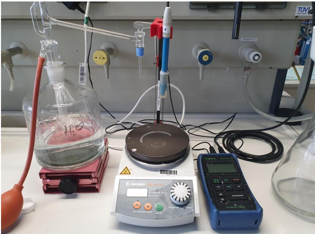
Abbildung 19: Aufbau der Einstellung der Schlammproben durch Titration
