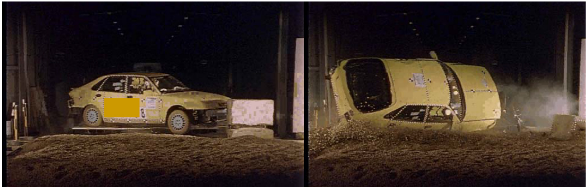
Abbildung 1.11.: Im weniger bekannten Bounce-Over-Versuchsszenario nach [105] wird ein Überschlag nach einer Kollision mit einem stehenden Hindernis nachgestellt. Nach der Kollision rutscht das Fahrzeug seitlich in ein Kiesbett und überschlägt (Bildquelle: [136]).
