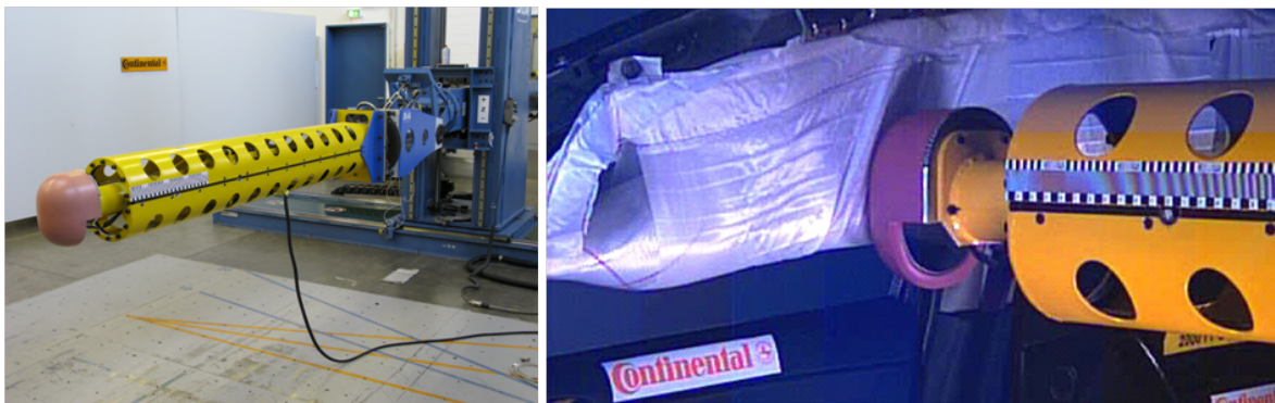
Abbildung 1.22.: Links: Dummykopf-Schussanlage für Ejection Mitigation; Rechts: Vollständig entfalteter Curtain Airbag im Augenblick des Impaktoraufpralls; FMVSS 226 schreibt vor, dass der Impaktor während des Tests nicht mehr als 4 inch ( \approx 10 cm) über die Scheibenebene hinausragen darf. Die Auslösung des Airbags wird dabei vom Testsystem durchgeführt. Ein Überschlagserkennungsalgorithmus wird dabei nicht überprüft.
