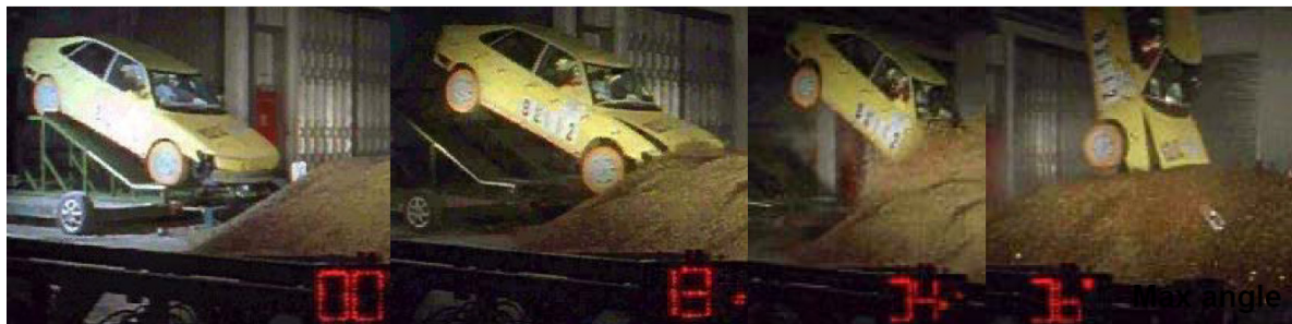
Abbildung 1.12.: Ein Überschlag um die Fahrzeugquerachse wird im Pitch-Over-Versuch simuliert. Dabei rutscht das Fahrzeug mit einem Anfangsnickwinkel von einem Rollwagen mit vorgegebener Geschwindigkeit frontal in ein Kiesbett, wodurch es sich über die Fahrzeugfront dreht und umkippt (Bildquelle: [136]).
