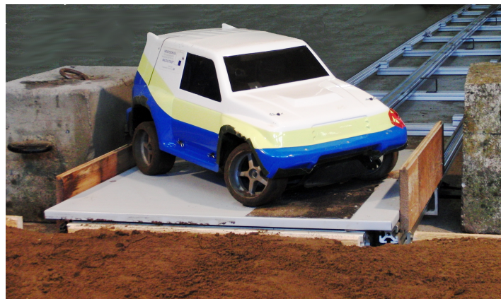
Abbildung B.1.: Skaliertes Versuchsfahrzeug auf der Schlittenanlage vor dem Sandbett
