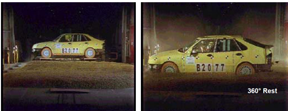
Abbildung 1.10.: Beim Gravel-Trip-Versuch wird das Fahrzeug erneut seitlich von einem Rollwagen geschleudert. Nach der Freiflugphase rutscht das Fahrzeug in ein Kiesbett. Dadurch sollen ebenfalls Turn-Over-Überschläge nachgestellt werden (Bildquelle: [136]).
