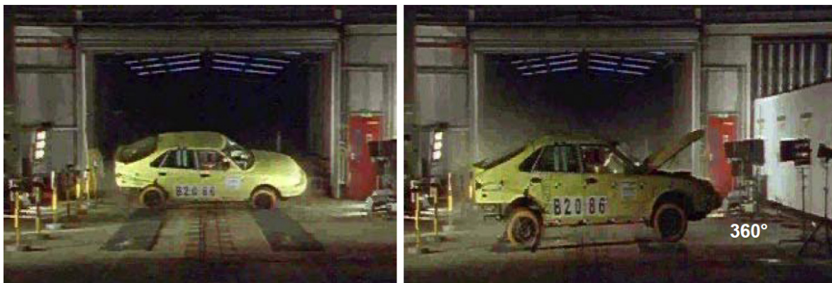
Abbildung 1.9.: Beim Friction-Trip-Versuch wird das Fahrzeug seitlich von einem Rollwagen geschleudert. Nach kurzer Freiflugphase treffen die Reifen auf eine Fahrbahn mit hohem Reibwert, wodurch Turn-Over-Überschläge simuliert werden (Bildquelle: [136]).
