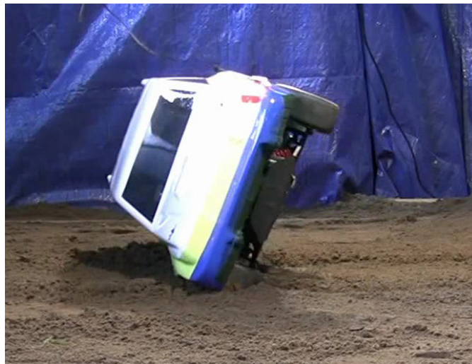
Abbildung 4.14.: Seitenansicht des Versuches #036 bei maximalem Rollwinkel. Das Fahrzeug kippt bis zu einem Winkel von \varphi_x = 68^\circ auf. Es handelt sich um eine extreme Grenzsituation, die sehr gefährlich für Insassen sein kann. Für ein Überschlagserkennungssystem stellt dieser Fall einen Graubereich dar. Der Versuch wird deshalb als „MayFire“ definiert, so dass eine Auslösung von Sicherheitssystemen akzeptabel aber nicht zwingend notwendig ist.
