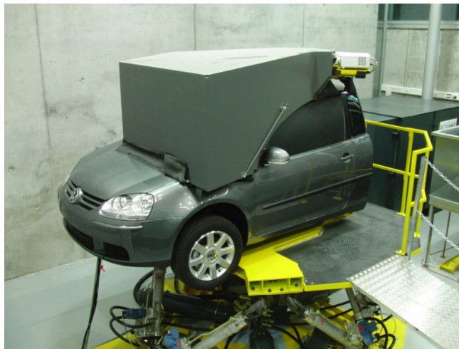
Abbildung 4.11.: Hexapoden-Fahrsimulator zur Durchführung der Fahrversuche
