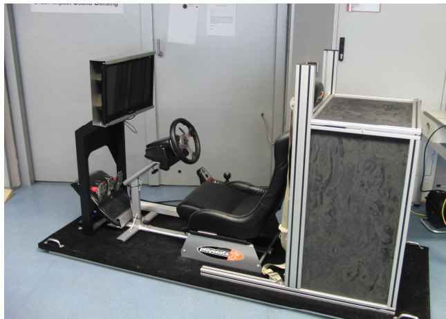
Abbildung 4.10.: Statischer Fahrsimulator mit reversiblen Gurtstraffer
