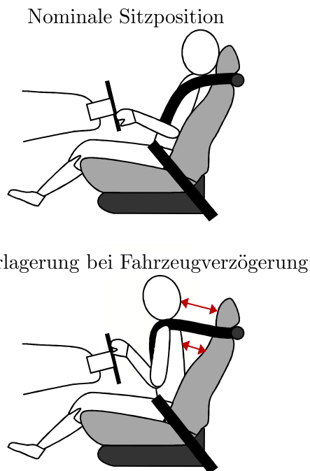
Abbildung 2.6.: Vergleich zwischen nominaler Sitzposition und vorverlagerten Position bei starker Bremsung
