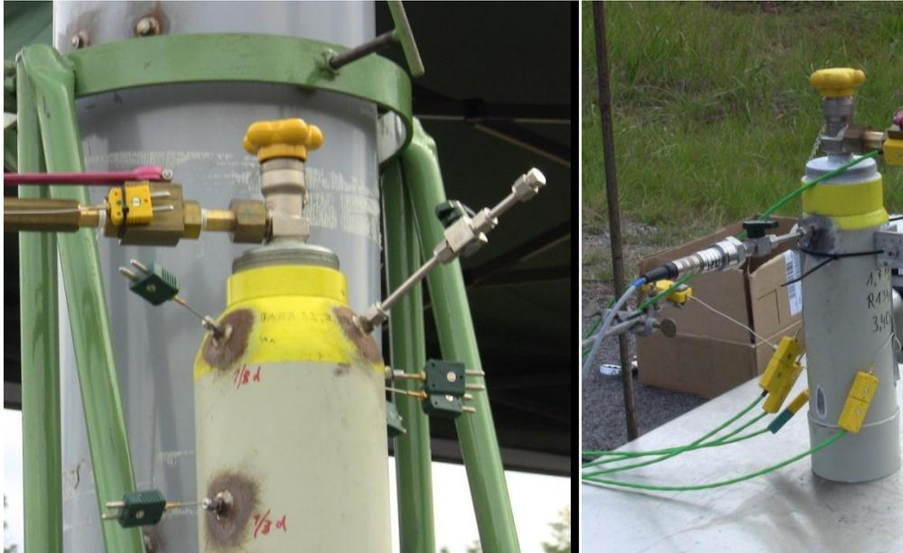
**Abbildung 12: Anbringung Thermoelemente und Druckaufnehmer**
