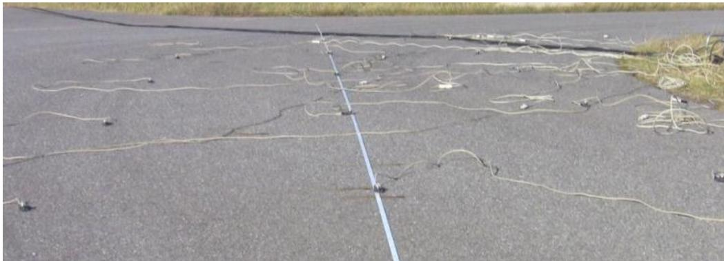
**Abbildung 24: Anordnung der Neutralgassensoren im Messfeld**
