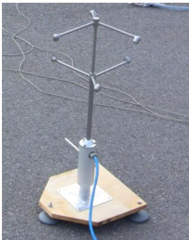
**Abbildung 7: Ultraschallanemometer USA-1**
