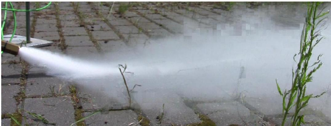
**Abbildung 44: Fotoaufnahme Flüssig- bzw. Zweiphasenströmung (Liegende Flasche)**
