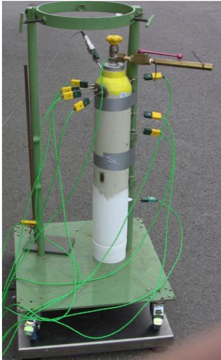
**Abbildung 10: Versuchsaufbau Freisetzung aus der Gasphase**
