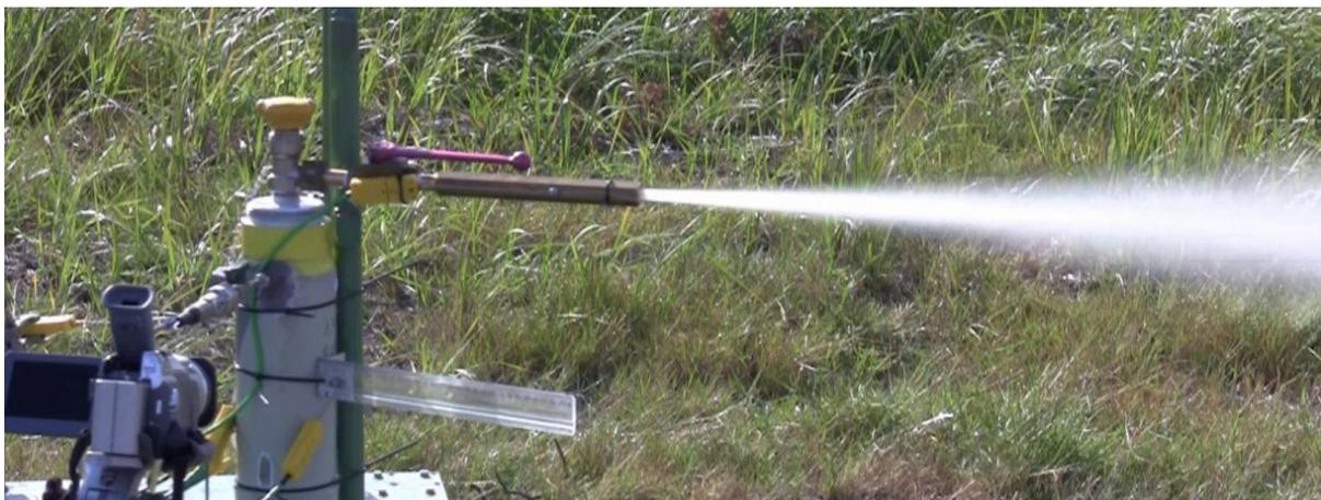
**Abbildung 29: Fotoaufnahme Zweiphasenströmung (Freisetzung aus der Gasphase)**
