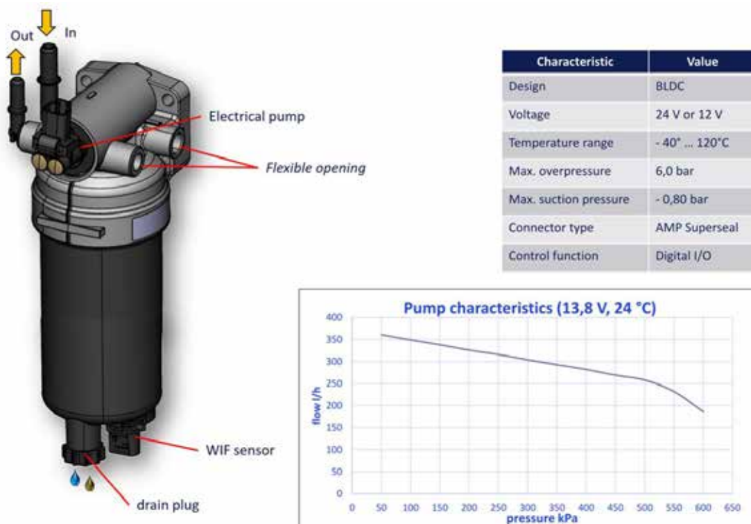
Abbildung 4: Integration und Kennlinie eine elektrischen Dieselpumpe
