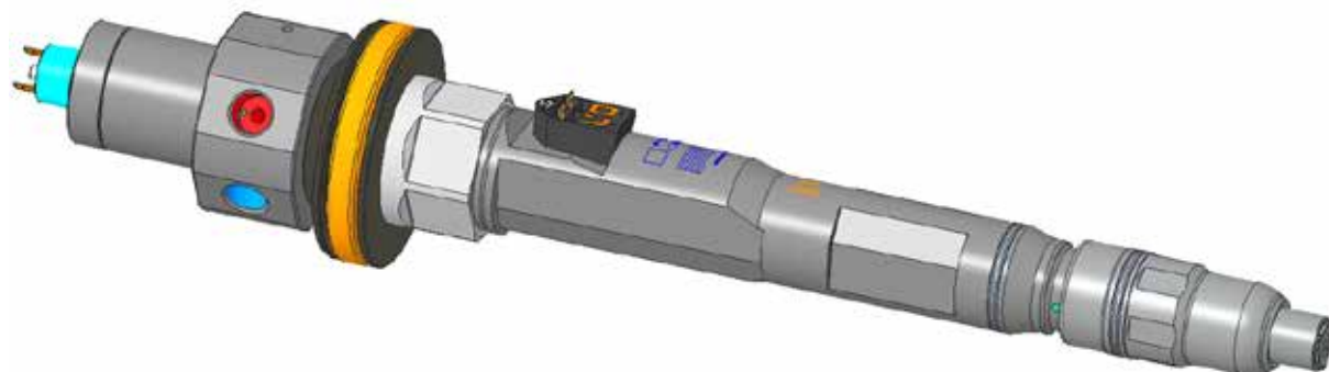
Abbildung 3: Schematische Darstellung HPDF-Injektor
