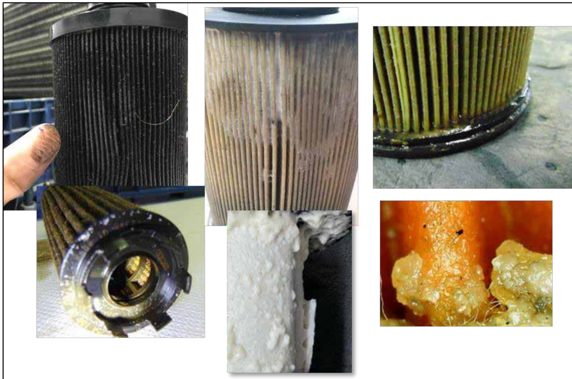
Abbildung 2: Unterschiedliche Arten von mikrobiellem Wachstum auf Kraftstofffiltern
