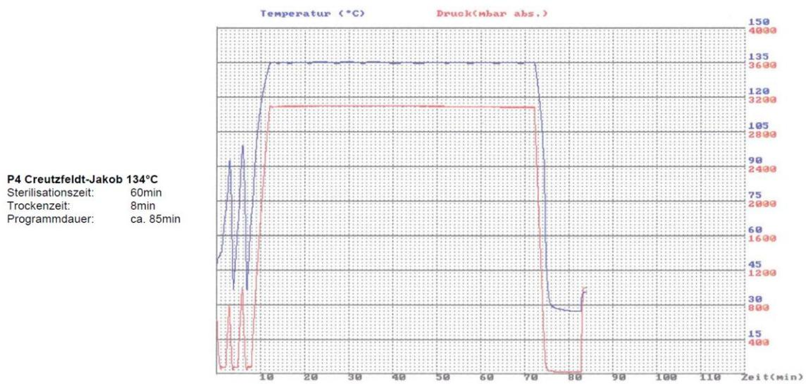
Abbildung 8-6: Ablaufdiagramm des P4 Creutzfeldt-Jakob-Programms für Dampfsterilisation
