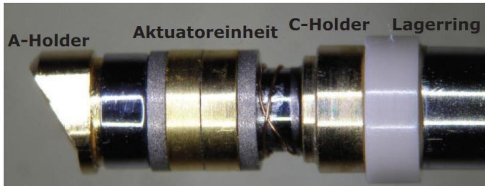
Abbildung 4-23: Distale Spitze der R-Unit eines Videoendoskops der Firma Olympus mit Aktuator-Einheit [Rein11]
