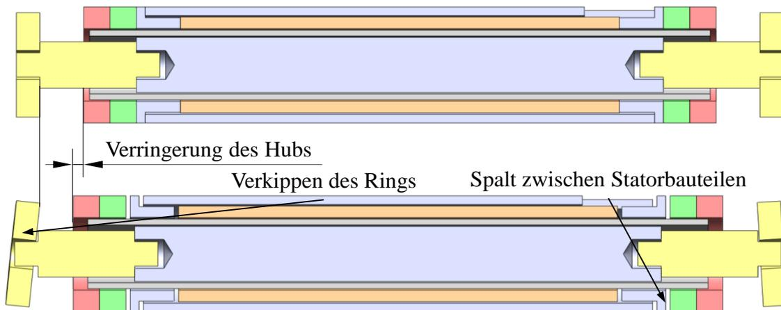
Abbildung 5-4: Schematische Darstellung von Lageabweichungen, die zu einer Verringerung des Hubs führen
