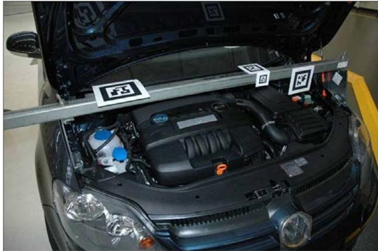
Abbildung 5-2: Individuelle Markeradapter bei der AR-Untersuchung eines Vorderwagens [Volkswagen AG]
