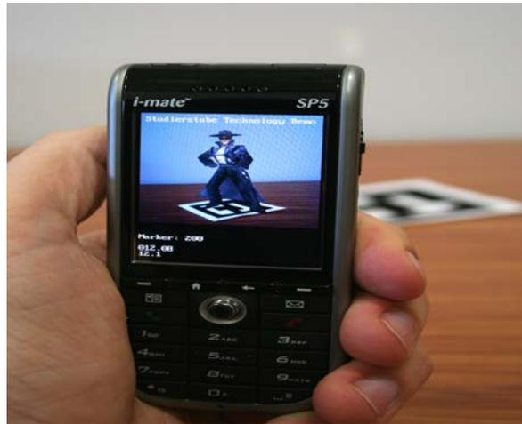
Abbildung 2-6: mobile AR-Anwendung auf einem PDA [SW07]
