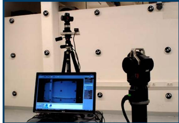
Abbildung 5-20: Kalibrierfeld ohne (links) und mit Photogrammetrieadaptern (rechts) [eigene Aufnahmen]
