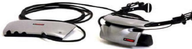
Abbildung 2-5: Emagin Visor HMD [Ema08]
