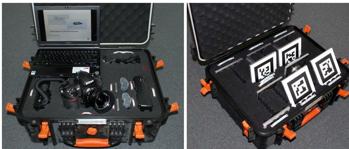
Abbildung 5-6: Setup AR-System: Kamera und Laptop (li); Adapter mit Markern (re) [eigene Aufnahme]
