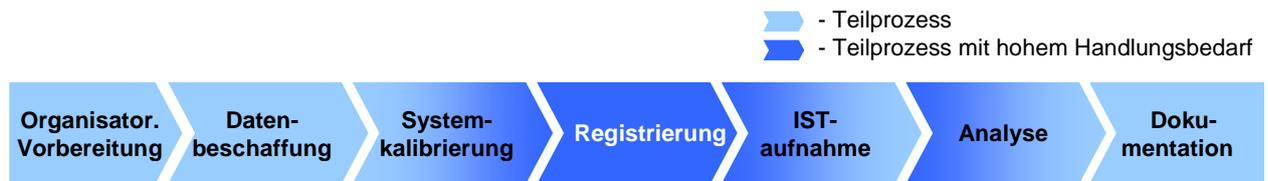
Abbildung 4-21: Handlungsbedarf bei AR-basierten Soll/Ist-Vergleichen von Betriebsmitteln [eigener Entwurf]
