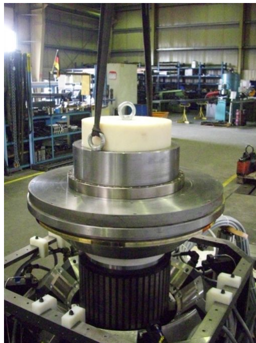
Abbildung 4.11.: Montage des Rotors
