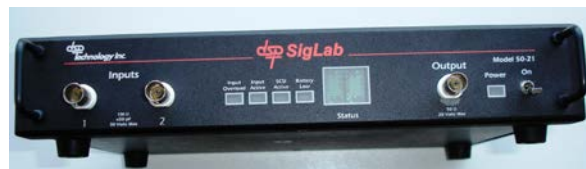
Abb. 33: Verwendete Messtechnik für die Schalldruckpegelerfassung. Links, Laptop PC, Rechts SigLab Analysator
