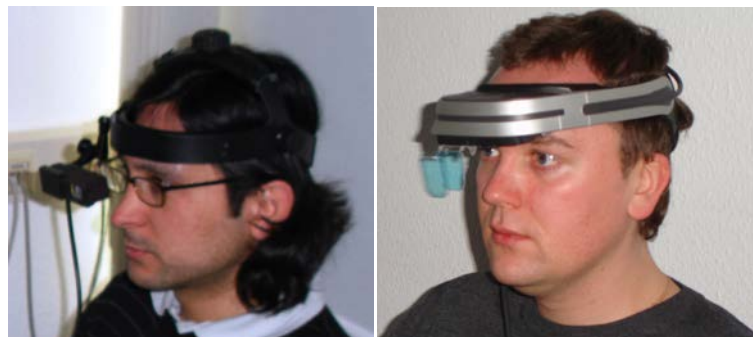
Abb. 1: Verwendeten Kopf-getragenen Displays. (Links) Gerät der Firma LitEye, LE-750A. (Rechts) Gerät der Firma Microvision, Nomad ND 2100
