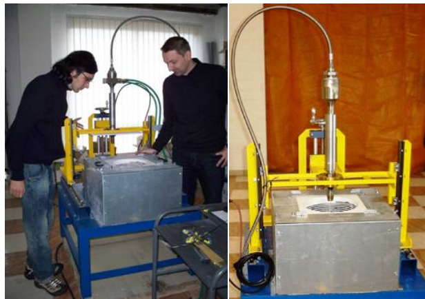
Abb. 2: Verwendete Pilotanlage für die Behandlung von Aluminiumschmelze
