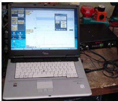
Abb. 33: Verwendete Messtechnik für die Schalldruckpegelerfassung. Links, Laptop PC, Rechts SigLab Analysator
