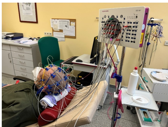
Abbildung 1: Routine-EEG nach dem 10/20-System mit der „Haube nach Schröter“ und Headbox auf dem Ständer
