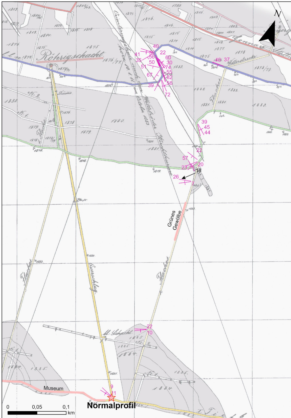
Abb. 7: Messwerte der Schichtflächen im Bereich des Röhrgeschachtes und Umgebung und einer Faltenachse nördlich des Grünen Gewölbes.
