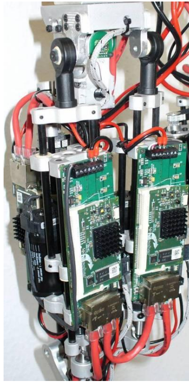
Bild 2.4 – Konstruktive Umsetzung des Hüftgelenks
