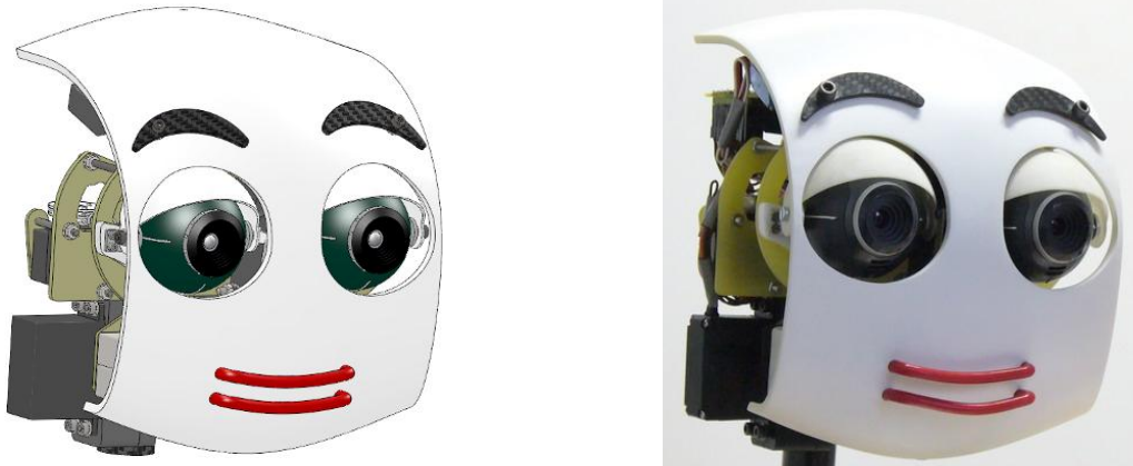
Bild 2.14 – CAD-Entwurf und Realisierung des Kopfes des interaktiven Roboters ROTTO
