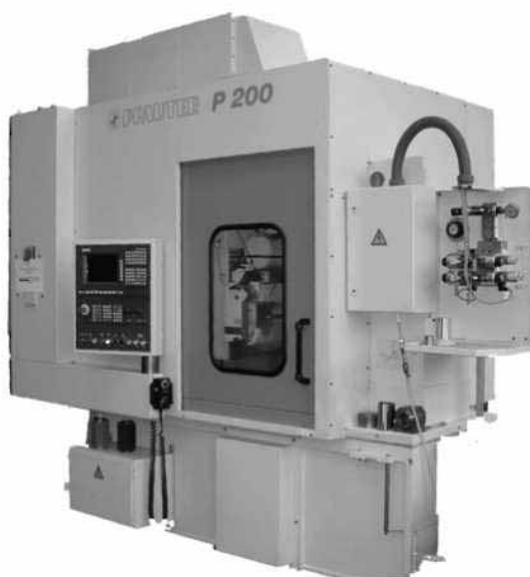
Bild 4-3: Ansicht der verwendeten Wälzfräsmaschine
