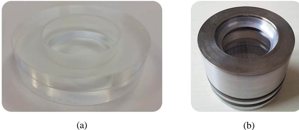
Abbildung 3.2: Optische Zugangsstellen: (a) Glasring; (b) Pancake Kolben
