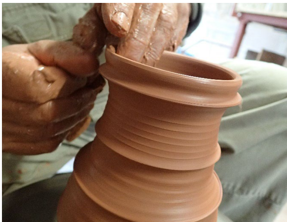
Abbildung 18: Formung eines Dornrandes an der Drehscheibe durch bestimmte Fingerhaltungen
