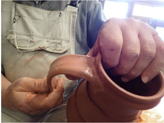
Abbildung 20: Ziehen eines angarnierten flachen Bandhenkels bei der Fertigung eines Kruges
