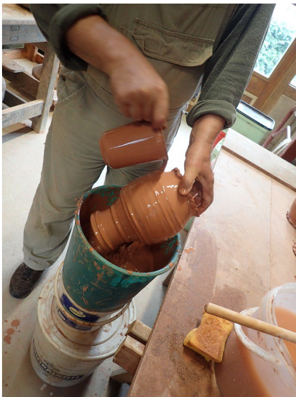
Abbildung 12: Töpfer Johannes Klett beim Begießen der Nachbildung eines mittelalterlichen Kruges mit Engobe aus Tonschlicker
