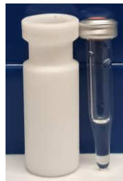
Abbildung 20: Glasinserthalter und Glasinsert mit 60 \mu\text{L} Dichlormethan
