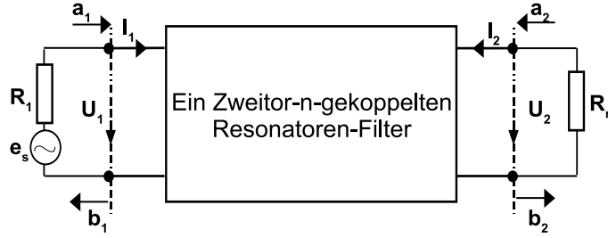
Abbildung 2.28: Äquivalent Netzwerk zu Abb. 27.
