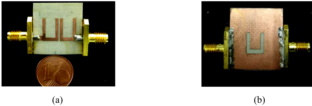
Abbildung 5.43: Fotos des gefertigten Filters: (a) Vorderseite, (b) Rückseite
