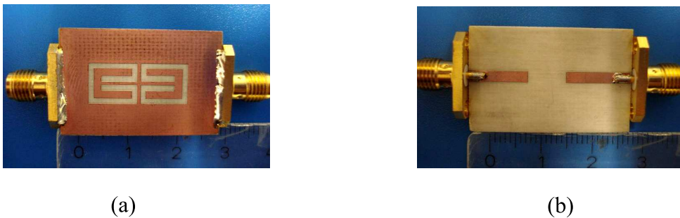
Abbildung 5.32: Foto des realisierten Bandpassfilters: (a) Rückseite, (b) Vorderseite
