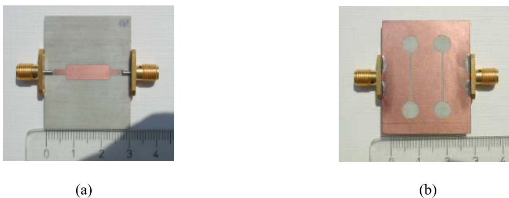
Abbildung 4.20: Fotografie: (a) Untere Schicht (Bottom Layer) der Filterstruktur, (b) Obere Schicht (Top Layer) des Rundkopf-DGS-Filters
