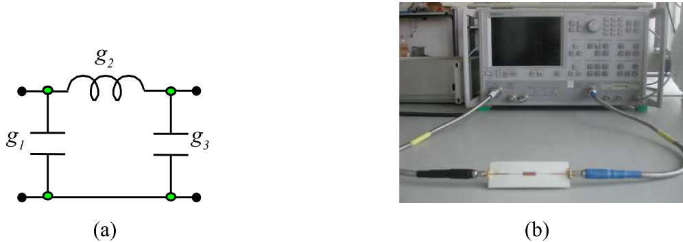
Abbildung 2.22: Hi-Lo-Filter: (a) Ersatzschaltbild, (b) die gefertigte Filterstruktur
