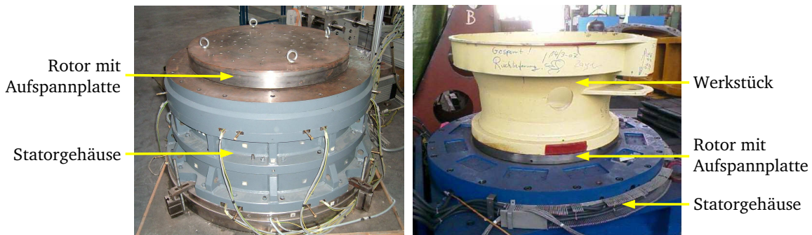
Abbildung 1.5. – Rundtisch Prototyp 1 ([8], [23], [26], [27]), (RTP1) mit Aufspannplatte (links) und Rundtisch Prototyp 2 ([23], [28], [29]), (RTP2) mit Werkstück im industriellen Umfeld (rechts)
