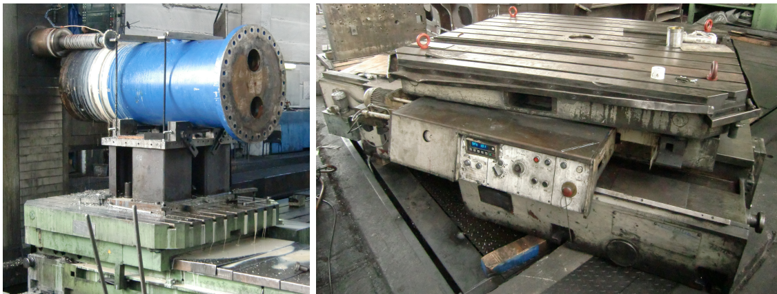
Abbildung 2.2. – Linearführung im Bearbeitungsprozess (links) und Drehtisch bei der Wartung (rechts) (Foto: GMV GmbH, Genthin, 2012)
