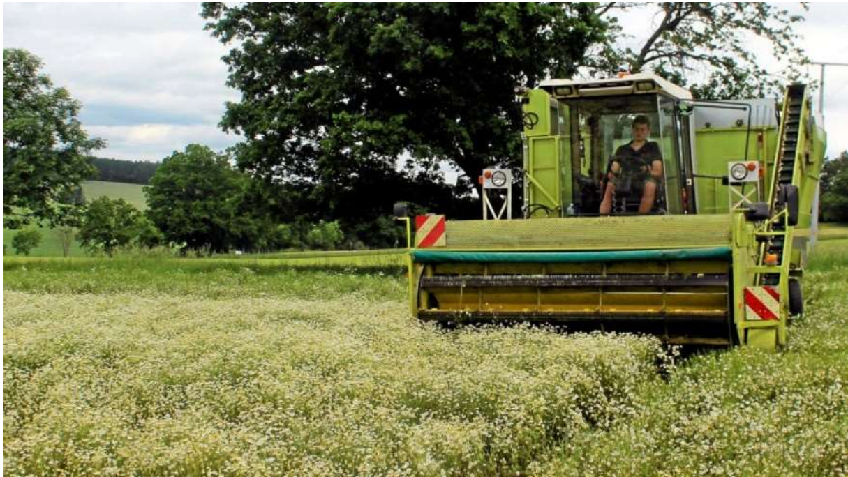
Abbildung 5: Kamille-Pflückmaschine Typ KEM Linz III (Foto Marcus Cislak)
