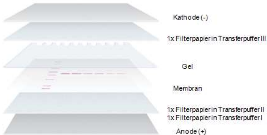
Abbildung 6: Aufbau des Semidry-Blot-Systems (Bio-Rad Laboratories GmbH Deutschland 2010)
