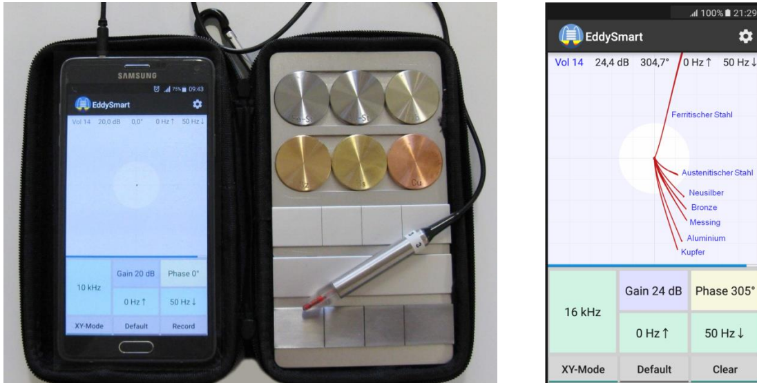
Abb. 1. Links: EddyCationSmart-Kit, bestehend aus einem Smartphone (hier Galaxy Note 4), dem Bezugskörper-Set und einem Absolutsensor. Rechts: Wirbelstromsignale der Ronden und des Grundkörpers.
