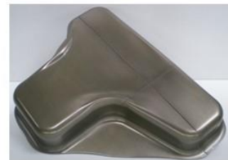
Stilisierter B-Säulen Fuß HSD®-Stahl; 1.5mm
