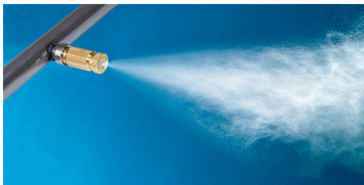
Figure 1.1: Die Abbildung 1 zeigt ein System zur Kühlung, Befeuchtung und Reinigung von Luft. Dabei wird mittels Druck Wasser in Form von Nebel der Luft zugeführt. Der Kühleffekt entsteht durch die sofortige Verdunstung des Wassers.
