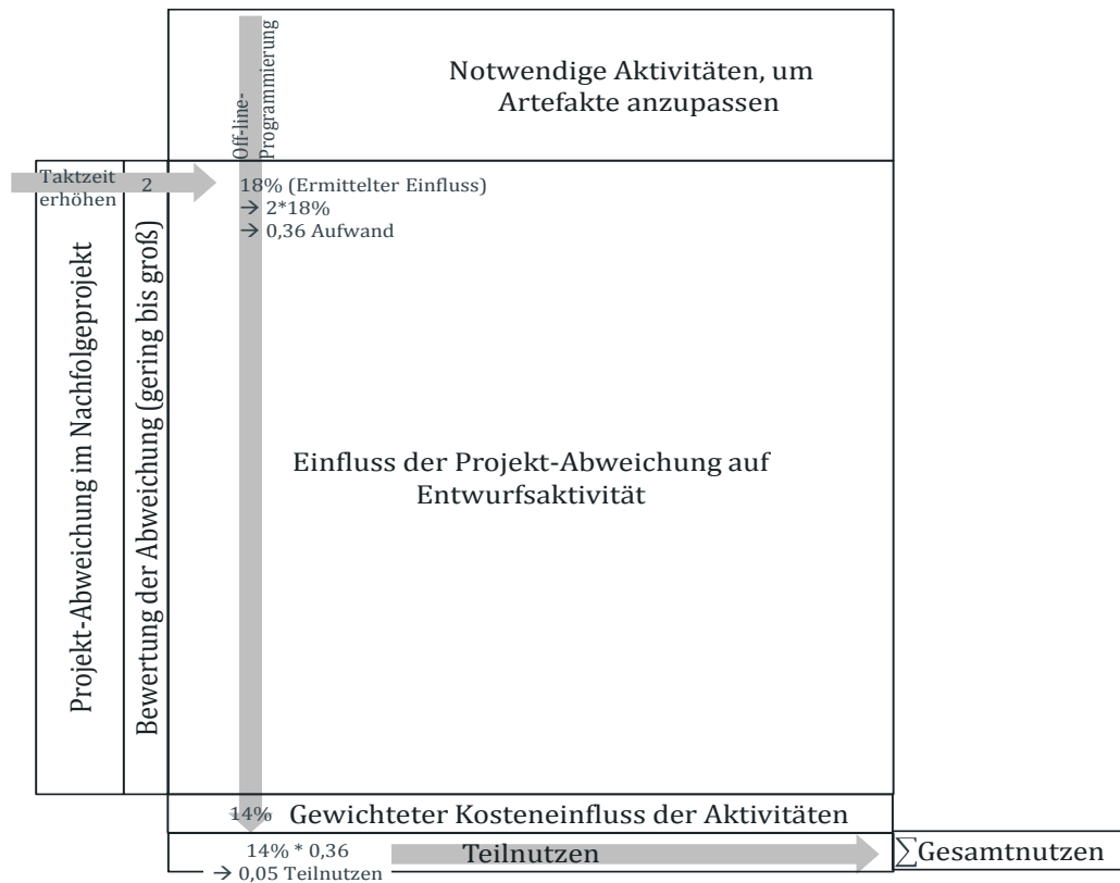
Abbildung 48: Auswahlverfahren für die Wiederverwendung von Entwurfsartefakten für den Karosseriebauanlagendesign in Anlehnung an [Knabe 2015]
