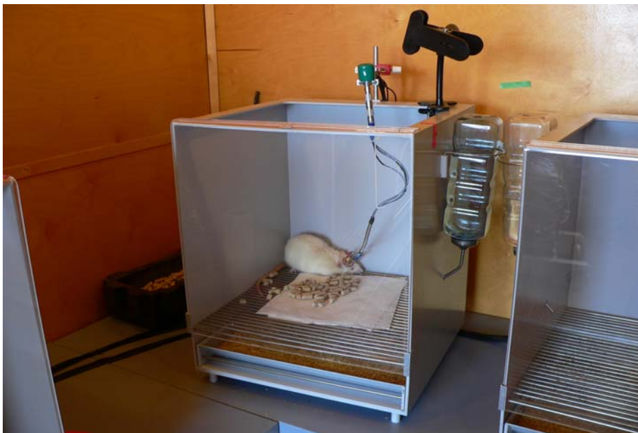
Abb. 11. Stimulations-, Ableitboxen mit einem Versuchstier, wobei die Verbindung des Versuchstieres mit dem Swivel und der freie Zugang zu Futter und Wasser dargestellt sind.
