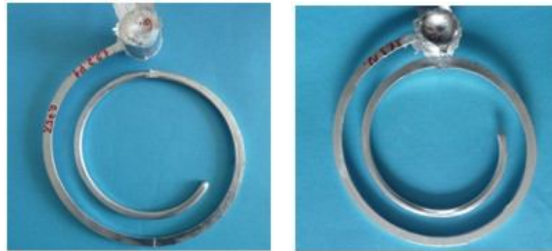
Bild 29. Spiralprobe AlSi7Mg0,3 (links) und AlSi11Mg (rechts)
