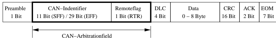
Abbildung B.1: Unterschiedliche Adressierungen bei Ethernet / CAN
