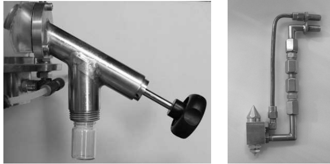
Abbildung 3.1: Probenahmeverrichtung (links) zur Entnahme von Wirbelschichtpartikeln für die externe Probenvermessung und konzentrisch eingebaute Zweistoffdüse Modell 970/0 S4 (SCHLICK DÜSEN GMBH).
