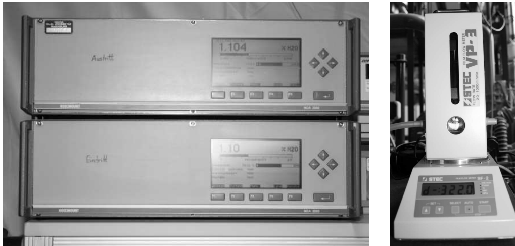
Abbildung 3.6: IR-Spektrometer für Ein- und Austrittsgas der Wirbelschichtanlage (links); Film Flow Meter Typ SF-2 der Fa. STEC zur Gasdurchflussmessung an den IR-Spektrometern (rechts).
