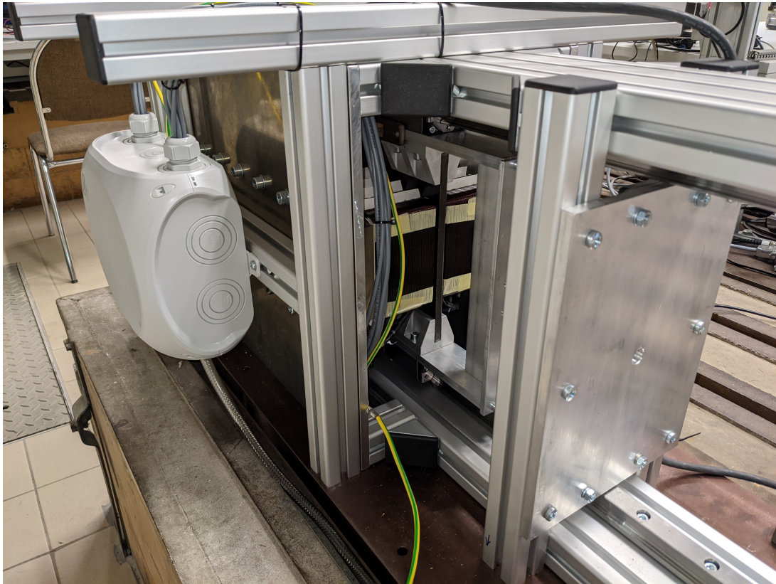
Abbildung 7.5. – Versuchszustand mit komplett montiertem Prototyp der Linearmaschinen
