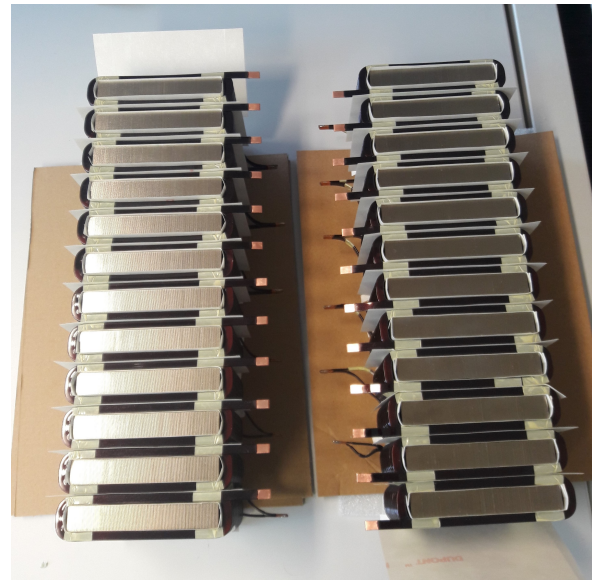
(b) Bestückung beider Statorhälften komplett
