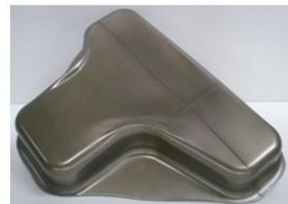
Stilisierter B-Säulen Fuß HSD®-Stahl; 1.5mm
