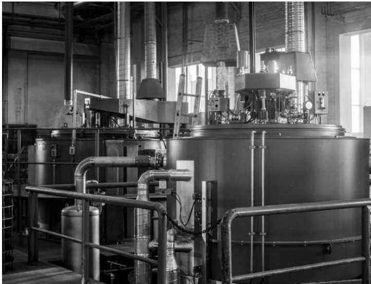
Abb. 3: Anlagentechnik für das Nitrieren und Nitrocarburieren inklusive Nachoxidation
