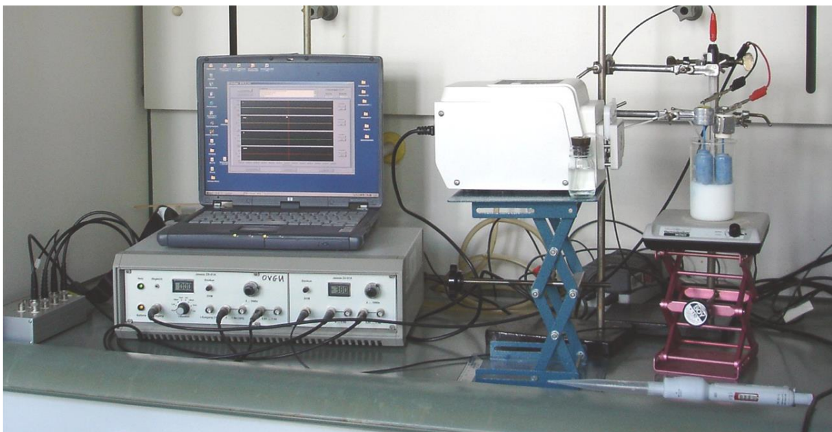
Abbildung 2: Versuchsaufbau für die Messung des elektrochemischen Rauschens in wässrigen Bindemittel-Dispersionen mit Zudosierung einer NaCl-Lösung
