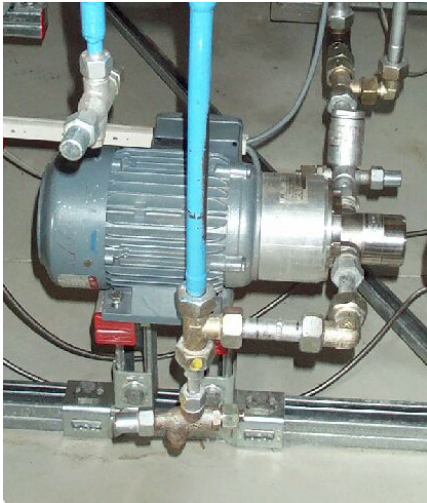
Abbildung A 1: Zahnradpumpe 8200 M037/2800/140 – Fa. SCHERZINGER Maße: \varnothing Motor: 14 cm \varnothing Pumpenkörper: 5 cm Gesamtlänge: 35 cm
