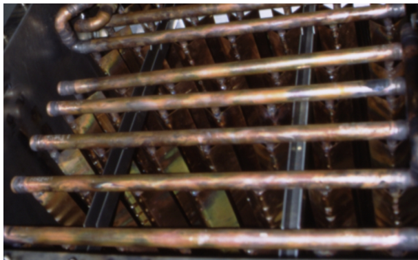
Abbildung 24: Kupferrohrwärmeübertrager im Latentwärmespeicher
