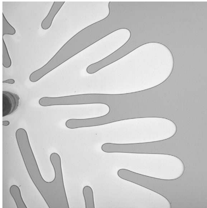
Abbildung 1.14: Luft treibt Glycerin in einer Hele-Shaw-Zelle mit Plattenabstand 500 \mu\text{m} . (Experiment in Kooperation mit Martin Böckmann.)
