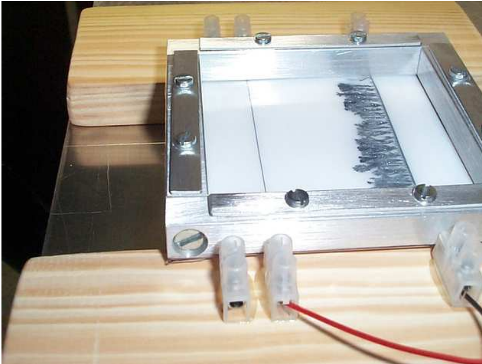
Abbildung 3.8: Infrarotmesszelle. Der Boden besteht aus Teflon, die obere Abdeckung aus Polyethylenfolie, die über einen Aluminiumrahmen gespannt ist. Die Elektroden sind parallele Zinkdrähte, welche mit Lüsterklemmen befestigt werden.
