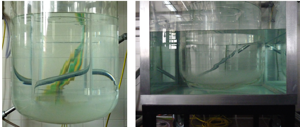
Abbildung 5.2: Optische Effekte an den gekrümmten Wänden des FPR-Mischers; links: stark verzerrtes Bild der hinter dem Mischbehälter liegenden Gegenstände; rechts: Verbesserung durch quaderförmiges, mit Wasser gefülltes Bassin.
