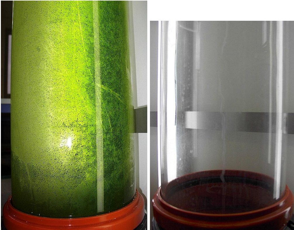
Abbildung 2.6: Biofilm-Belagbildung in einem Fotobioreaktor nach einwöchiger Fermentation von Chlorella vulgaris ; links: ohne RST deutlich erkennbarer Biofilm; rechts: mit Einsatz von RST ist optisch kein Belag zu erkennen (entnommen aus Säuberlich (2012)).
