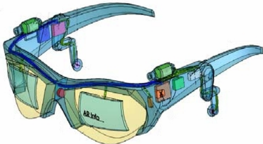
Abbildung 3.5: Entwurf eines HMDs für das AR -gestützte Training
