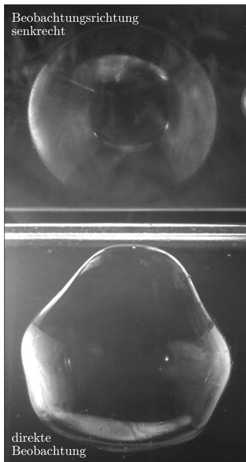
Abbildung 5.6: Schwingende Seifenblase mit einem Durchschnittradius von etwa 47 mm, aus zwei Richtungen beobachtet. Die direkte Beobachtung ist im unteren Teil zu sehen. Der obere Teil entspricht dem Bild im 45° gekippten Spiegel, also der Abbildung senkrecht zur direkten Beobachtungsrichtung. Im oberen Bild ist zu erkennen, dass die Rotationssymmetrie der Blase erhalten blieb. Die Annahme m = 0 (keine Abhängigkeit bzgl. \vartheta ) ist also gerechtfertigt.
