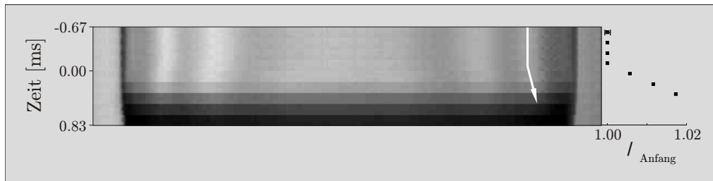
Abbildung 3.25: Das Bild zeigt die zeitliche Abhängigkeit des horizontalen Querschnitts durch eine smektische Blase. Der sphärische Film bestand aus der Substanz 8CB. Die Filmdicke betrug 2310 nm, der Radius 4,5 mm. Die Zeitachse verläuft von oben nach unten. Die Verschiebung der Interferenzringe (weißer Pfeil) bestätigt die im vorigen Abschnitt gefundene Erhöhung der Filmdicke.
