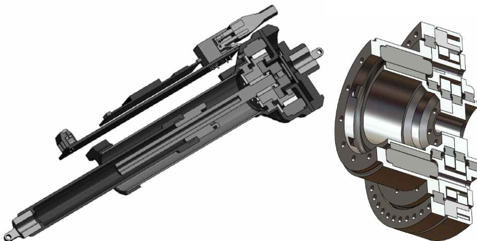
Abb. 2.5 – Kompakte RoboDrive- basierte Antriebe für zweibeinigen Roboter ROTTO
