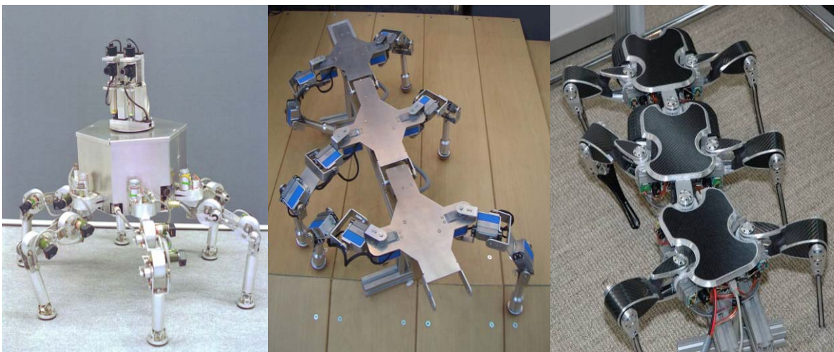
Abb. 2.7 - Mobile Schreitroboter KATHARINA, SLAIR1 und SLAIR2
