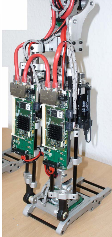
Abb. 2.15 – Konstruktive Umsetzung des Sprunggelenks für zweibeinigen Roboter ROTTO
