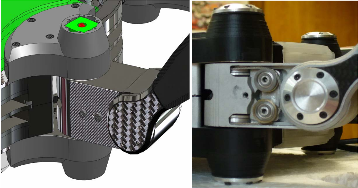
Abb. 2.11 – Aufbau des Schultergelenkmoduls des mobilen Roboters ANTON
